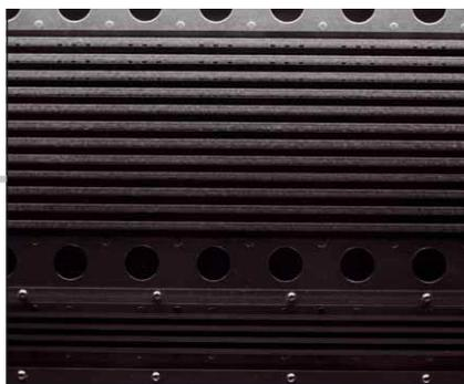
Das nackte Panel ohne Bespannung: Unten ist der Hochtöner mit 4 Magnetbahnen zu sehen, darüber der große Magnetostat mit deren 12
